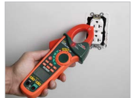
Detección de voltaje sin contacto (VSC).
