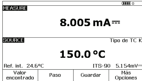
Figura 28. Pantalla de calibración de instrumentos de proceso
