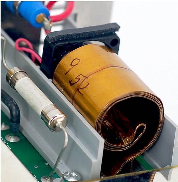
Derivador en espiral (Spiral Shunt) para la entrada de 30 A
