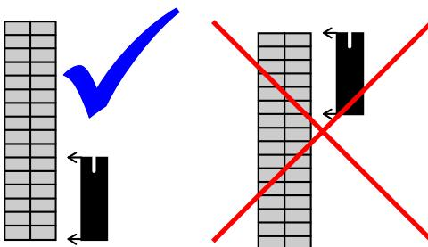
Pour les CI à trois pattes de type TO220 et T092, insérez le composant dans les broches 6, 7 et 8 du socle (en bas à gauche) avec le détrompeur ou le plat dirigé vers la droite.
