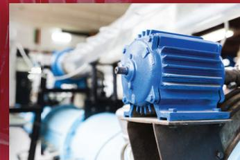
Prueba **todos los tipos de motores de corriente alterna** (de cualquier tensión), incluyendo los de inducción, síncronos, y los motores monofásicos. Se evalúa el estado eléctrico de todos los componentes del motor, incluidos los bobinados del estator y el rotor; conexiones y cables asociados.
