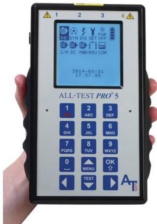
Se conectó el AT5™ al panel de control del motor y se realizó un análisis del circuito del motor™ en el motor del carro de 20 caballos de potencia. En sólo unos minutos, los resultados de las pruebas mostraron una lectura del aislamiento de tierra desconcertante de 10,1 Megohm (véase imagen 1).
