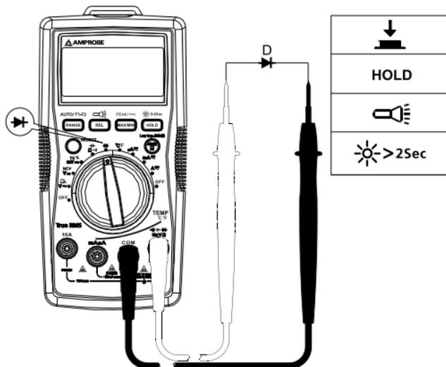
**Remarque :** Une tension de jonction typique chute de 0,5 V à 0,8 V.
