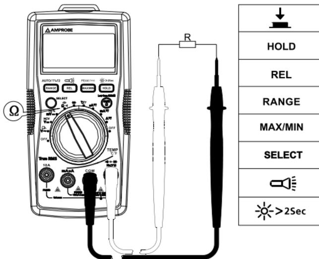
**Nota:** quando si misurano resistenze elevate (> 1 MΩ), possono trascorrere alcuni secondi prima che la lettura si stabilizzi.
