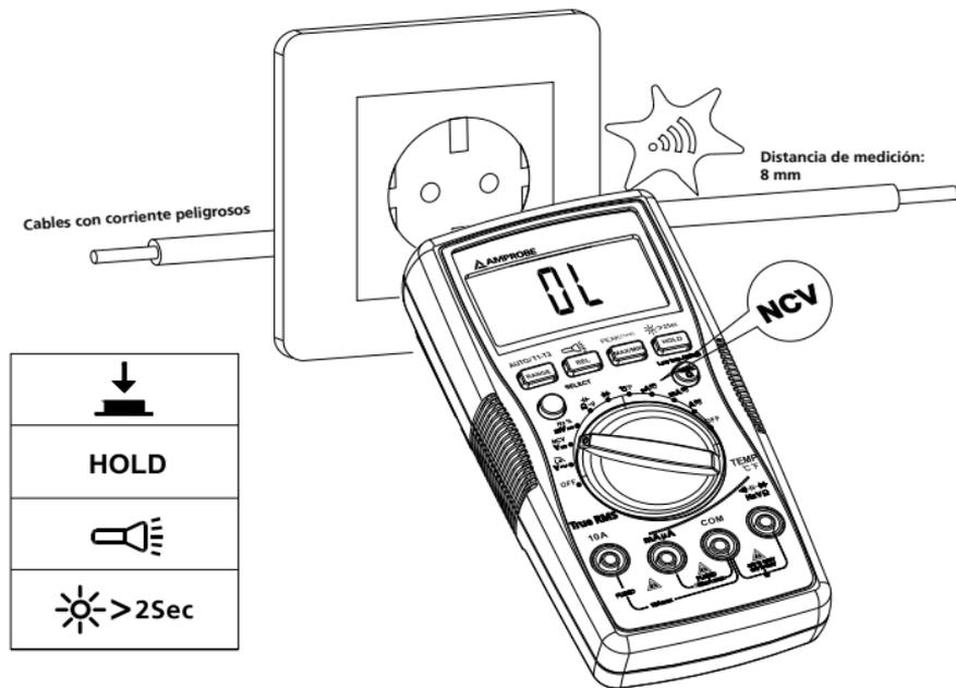
Sonará el zumbador cuando se detecten tensiones  $\geq 90$  V, y el zumbador permanecerá encendido. La distancia entre el cable y el medidor deberá ser  $\leq 8$  mm.
