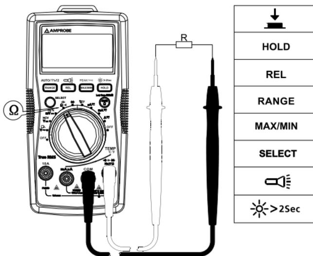
**Nota:** Al medir resistencias superiores a ( $>1 \text{ M}\Omega$ ), la medición puede tardar unos segundos en estabilizarse.
