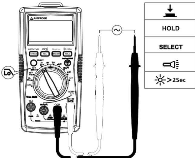
**Remarque :** Le multimètre passe en mode manuel lorsque le mode du filtre passe-bas est validé. Le mode de gamme automatique n'est pas disponible pour l'option du filtre passe-bas.
