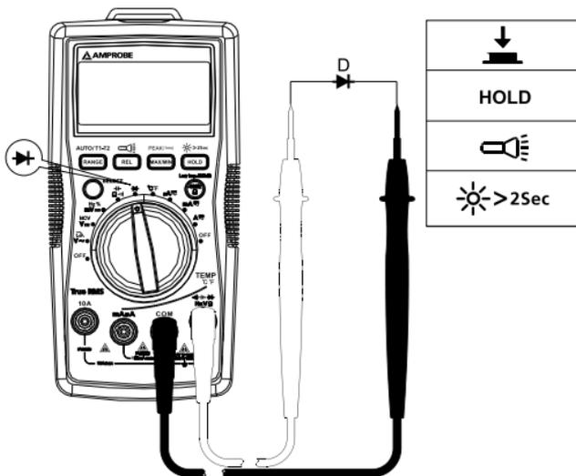
**Nota:** la caduta di tensione ai capi della giunzione di un diodo normalmente è compresa tra 0,5 e 0,8 V.
