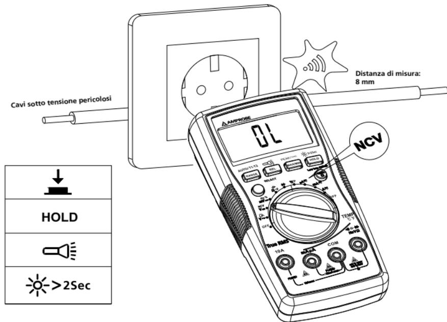
Quando la tensione rilevata è  $\geq 90$  V, viene emesso un segnale acustico. La distanza tra il cavo e il multimetro deve essere  $\leq 8$  mm.
