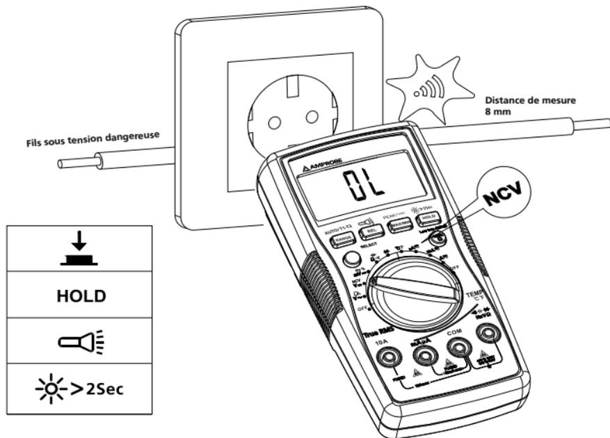
L'avertisseur retentit lorsque la tension détectée est  $\geq 90$  V et que l'avertisseur est activé. La distance entre le fil et le multimètre doit être  $\leq 8$  mm.
