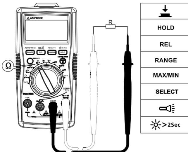
**Remarque :** Sur une mesure de résistance supérieure ( $> 1 \text{ M}\Omega$ ), il faut parfois attendre quelques secondes pour obtenir une lecture stable.
