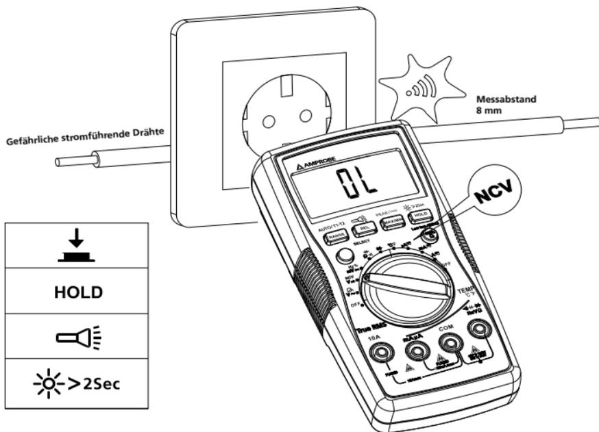
Der Piepser ertönt, wenn die erkannte Spannung  $\geq 90$  V ist; der Piepser ist eingeschaltet. Der Abstand zwischen dem Draht und dem Messgerät sollte  $\leq 8$  mm sein.
