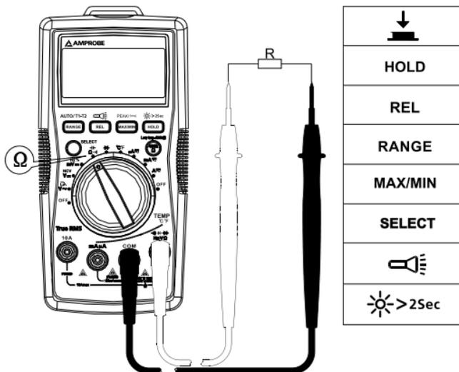
**Hinweis:** Beim Messen eines höheren Widerstands (> 1 MΩ) kann es ein paar Sekunden dauern, bis die Funktion einen stabilen Messwert erzeugt.
