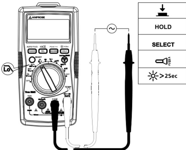
**Hinweis:** Das Messgerät schaltet in den manuellen Modus, wenn der Tiefpassfiltermodus aktiviert wird. Der automatische Bereichswahlmodus ist für die Tiefpassfilteroption nicht verfügbar.
