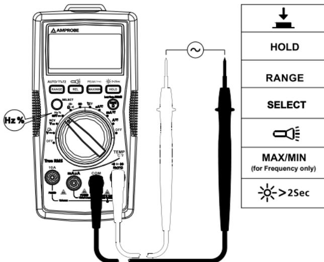
2. Misura della frequenza mediante la funzione misure di tensione AC
