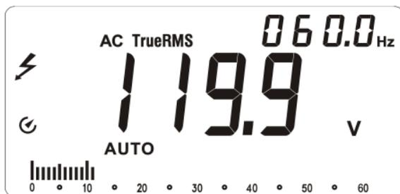
3. Misura della frequenza mediante la funzione misure di corrente alternata
