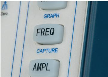
La función de captura con un simple botón permite adquirir y guardar señales desde los canales del osciloscopio a la memoria interna del generador directamente de manera fácil y rápida. Además de capturar las señales de los canales (CH1 y CH2), puede capturar y almacenar funciones matemáticas aplicadas a estos canales.
