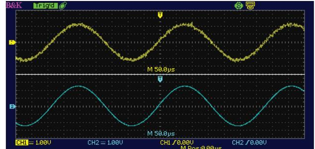
Utilice los filtros digitales incorporados para filtrar los componentes no deseados de una señal, tales como tipos de ruido. Elija entre los filtros Pasa-bajo, Pasa-alto, Pasa-banda, y Rechaza-banda.
