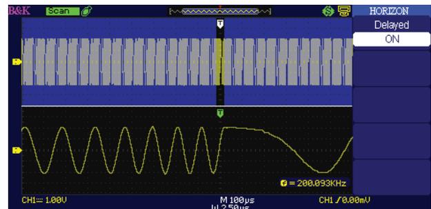
Utilice la característica de barrido retardado del osciloscopio para hacer zoom en cierta área de la señal en tiempo real, mientras observa la forma de onda capturada completa simultáneamente.
