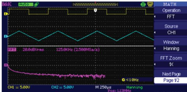
Mida y muestre el espectro de frecuencias de una señal de entrada. Seleccione una de las cuatro ventanas FFT: Rectangular, Hanning, Hamming y Blackman. Utilice los cursores para medir los componentes de magnitud y frecuencia del espectro.
