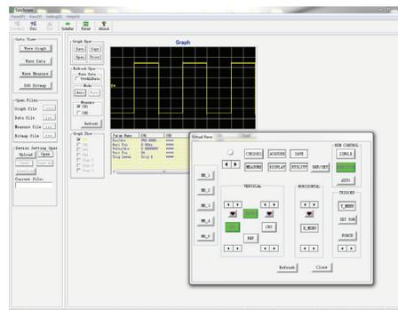
El software para PC suministrado gratuitamente (para descarga de [www.bkprecision.com](http://www.bkprecision.com)) permite una integración transparente entre el osciloscopio y la PC. Capture y transfiera formas de ondas e imágenes de pantalla, configuraciones y resultados de mediciones a una PC Windows vía el puerto de dispositivo USB en la parte posterior del instrumento o el USB host del panel frontal para acceso rápido y capturas de pantalla fáciles.
