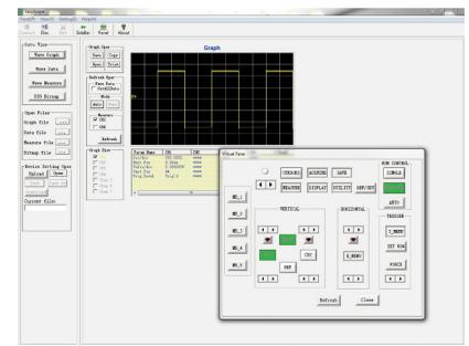
El software para PC proveído gratuitamente brinda una integración transparente entre el osciloscopio y la PC (para descarga desde [www.bkprecision.com](http://www.bkprecision.com)). Capture y transfiera formas de ondas, imágenes de pantallas, configuraciones y resultados de medidas a una PC Windows vía el puerto de dispositivos USB lateral del instrumento. Un puerto USB host también está disponible para salvar la pantalla de manera fácil y rápida.
