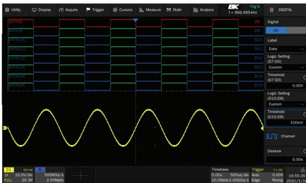
La función MSO (Osciloscopio de Señales Mixtas) agrega 16 canales digitales que permiten la adquisición y disparos de formas de ondas de señales mixtas.
