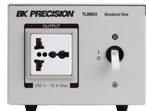
Esta caja de conexión universal Modelo TLBB53 simplifica la conexión de línea AC entre el medidor de poder y el dispositivo en prueba, y elimina la necesidad de cortar el cable de alimentación y pelarlo para conectar el medidor de poder. Esta caja facilita conexiones de entrada utilizando un enchufe universal que respalda la mayoría de los enchufes utilizados alrededor del mundo. También provee un interruptor de cortocircuitos para brindar protección adicional.
