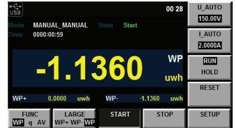
La función de integración es útil para analizar la energía eléctrica adquirida o proveída de sistemas de potencia de la red. El medidor 5335B brinda funciones de corriente integral y potencia activa integral (Wh) utilizando la conmutación de rangos para resultados de mediciones más precisos.
