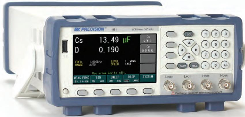
El Modelo 891 de BK Precisión es un Medidor LCD compacto, preciso, y versátil, capaz de medir inductores, capacitores y resistencia en DC o de 20 Hz a 300 kHz. El factor de forma 2U del instrumento para medio estante, es apto para su instalación en estante montable o uso de banco. Una pantalla grande a color con todos los parámetros importantes y mediciones visibles en una sola pantalla, hacen que el medidor sea fácil de operar.
