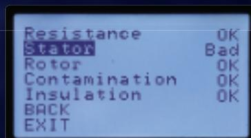
No todas las fallas del bobinado comienzan como fallas de conexión a tierra. En cambio, pueden comenzar como una debilidad en el sistema de aislamiento del bobinado que, eventualmente, puede fallar a tierra cuando el motor deja de funcionar.
