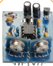
ARX-SNK ARX IR Heat Sensor
