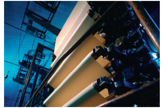
Monitorear las temperaturas de orilla y la uniformidad del secado resulta en altos rendimientos y tiempos muertos reducidos durante la producción de papel.
