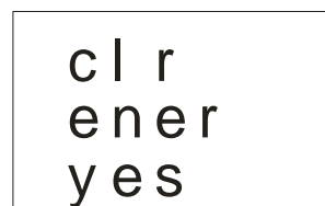
Figura 45 . Borrado de contadores de Energía
