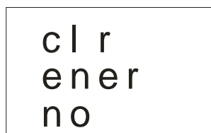
Figura 44 . No borrado de contadores de Energía
