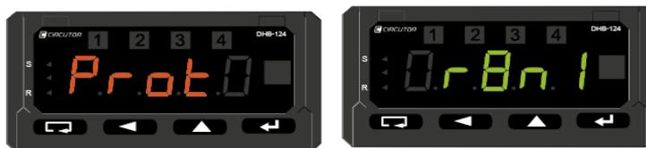
Figura 47: Pantallas de configuración de las comunicaciones Modbus: Protocolo de transmisión.
