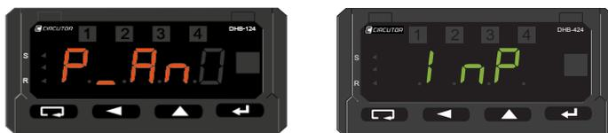
Figura 42: Pantalla de configuración de la salida analógica: contador.
