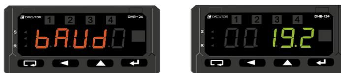
Figura 46: Pantallas de configuración de las comunicaciones Modbus: Velocidad de transmisión.
