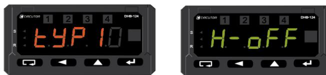
Figura 35: Pantallas de tipos de alarmas.
