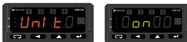
Figura 54: Pantalla de configuración de visualización de la unidad de medida.
