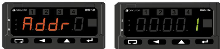
Figura 48: Pantallas de configuración de las comunicaciones Modbus: Dirección Modbus.
