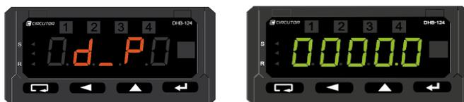
Figura 24: Pantallas de configuración del punto decimal del display.
