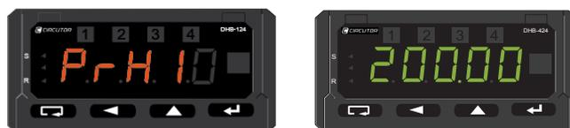
Figura 37: Pantallas del valor alto de alarma.
