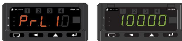
Figura 36: Pantalla del valor bajo de alarma.
