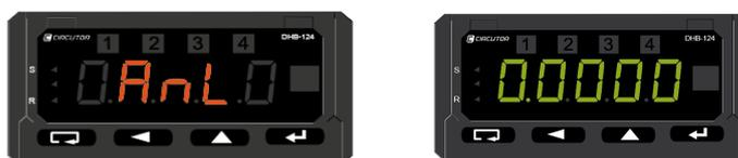
Figura 44: Pantalla de configuración de la salida analógica: valor cero.
