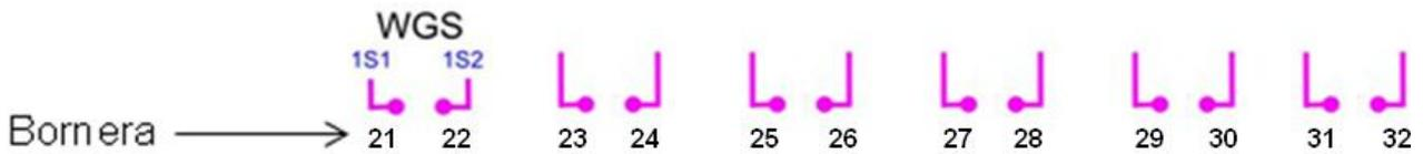
**5.5.- 2 salidas relé/ 2 salidas pulsos/ 2 entradas contaje impulsos**
