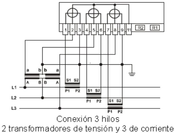
**El esquema de conexionado que hay que realizar, se encuentra marcado por láser en la tapa frontal del contador**
