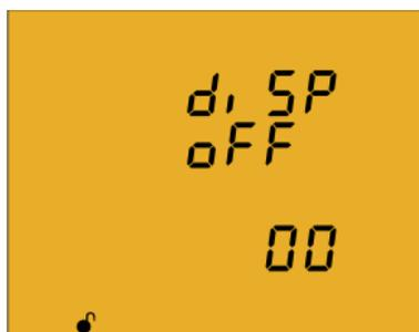
En esta pantalla se programa el tiempo que el Backlight permanecerá encendido (en segundos) desde la última manipulación del equipo mediante el teclado.
