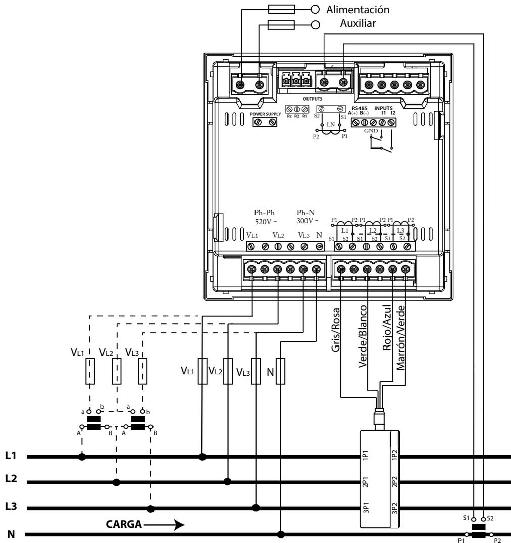
Figura 7: Medida trifásica con conexión a 4 hilos, modelo CVM-C10-MC-IN.
