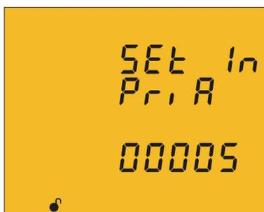
En esta pantalla se programa el primario del transformador de corriente de neutro.
