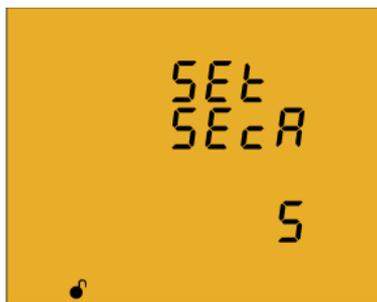
En esta pantalla se selecciona el secundario del transformador de corriente.
