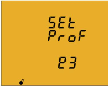
En esta pantalla se selecciona el perfil de funcionamiento del equipo.
