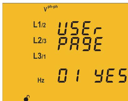
En esta pantalla se visualiza la primera pantalla de perfil **analyzer**, *Tensión fase-fase* y se selecciona si se quiere visualizar en el perfil **user** o no.
