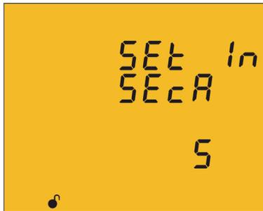
En esta pantalla se selecciona el secundario del transformador de corriente de neutro.
