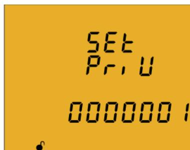
En esta pantalla se programa el primario del transformador de tensión.
