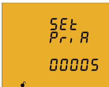
En esta pantalla se programa el primario del transformador de corriente.
