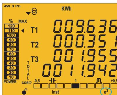
Figura 31: Pantalla del CVM-C10 con el perfil de funcionamiento e<sup>3</sup>.
