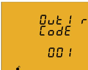
En esta pantalla se selecciona el código de la variable, en función de la **Tabla 15**, que controlará el relé de alarma 1.
