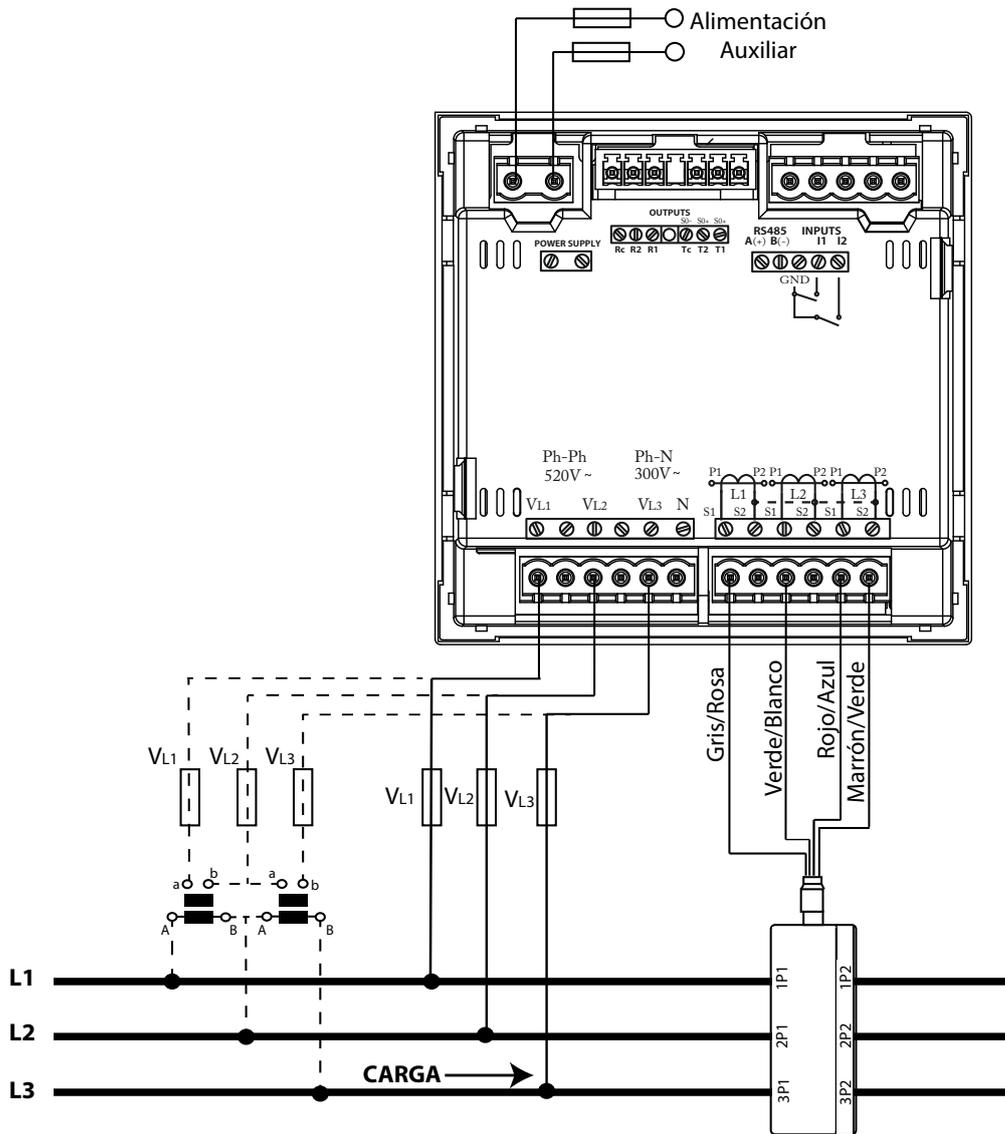
Figura 10: Medida trifásica con conexión a 3 hilos, modelo CVM-C10-MC.
