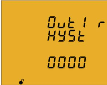
En este punto se programa el valor de histéresis, la diferencia entre el valor de conexión y desconexión de la alarma, en %.
