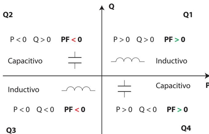
Valores del  $\cos \varphi$  en funcionamiento receptor (Q1, Q4)
