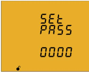
En esta pantalla se introduce el password de bloqueo o despliegue de la programación.
