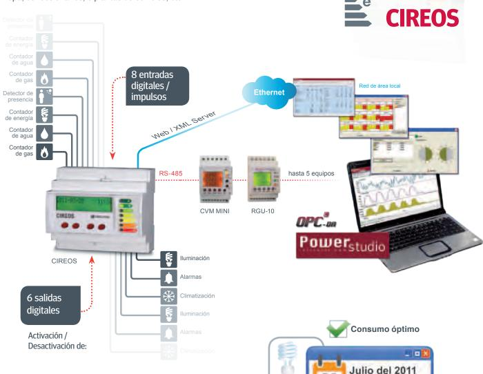
CIREOS, le permite determinar el nivel de eficiencia energética correspondiente a un edificio, comparando el consumo de un año a otro.
