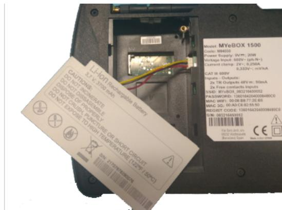
Figura 3: Conectar la batería.
