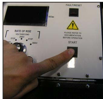
7.9. Después de registrar el voltaje de ruptura, presione el botón **Reset / Fault** que permite volver a cero el control de salida.
