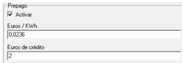
Permite activar la configuración de coste por kWh e importe máximo que se puede descargar en una recarga. Esto impide que pueda vaciarse la tarjeta de un usuario por error, poniendo un límite a la descarga. Como en el control de potencia, la gestión de la descarga máxima, es opcional.
