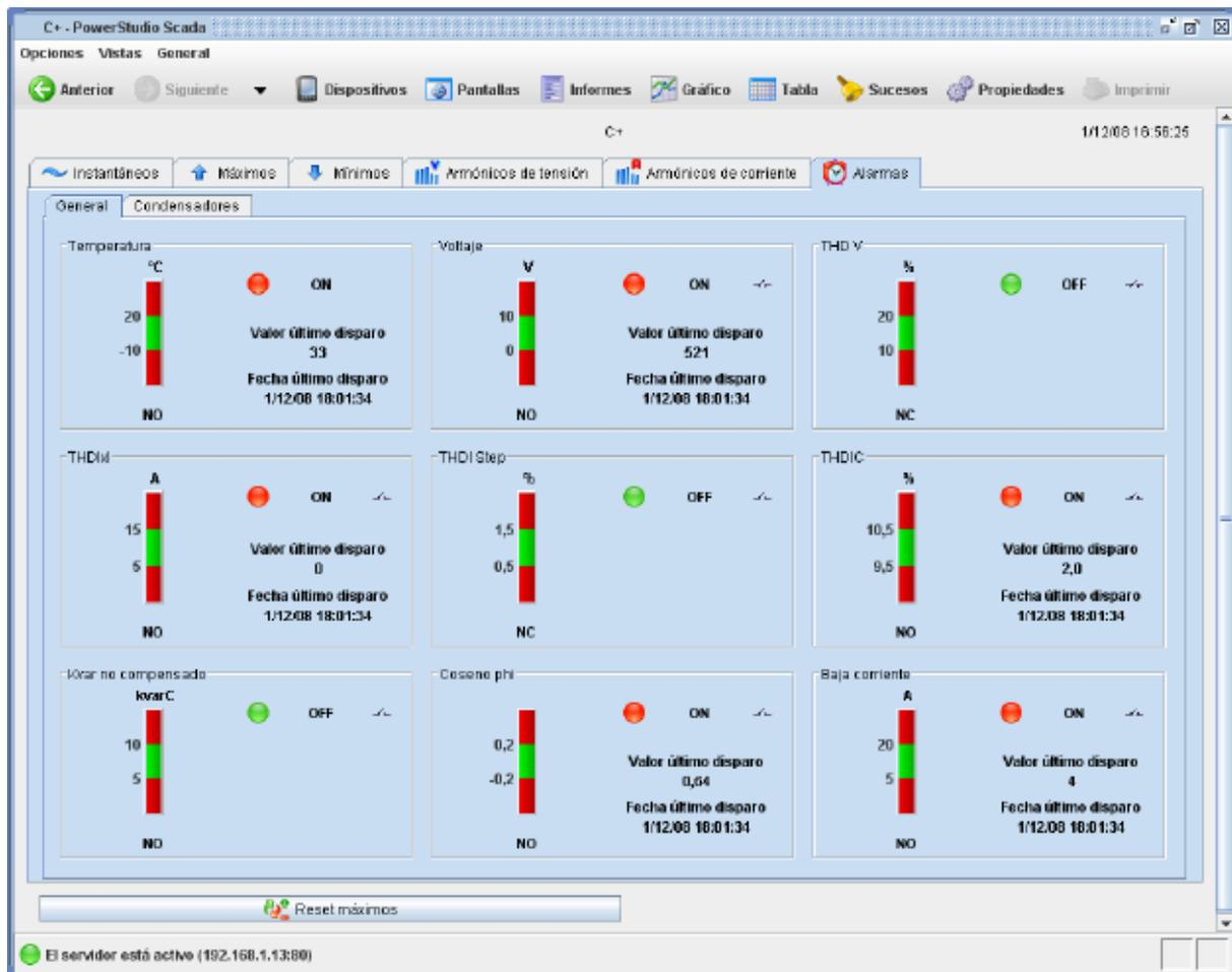
Otra de las pantallas especiales es la de alarmas del dispositivo Computer Plus. Para cada alarma podemos ver una barra de nivel con el valor máximo y mínimo configurado, si se dispara por NC (normalmente abierto) o NO (normalmente cerrado), el valor y fecha del último disparo, si la alarma esta actualmente disparada y si la alarma está asignada al relé global.
