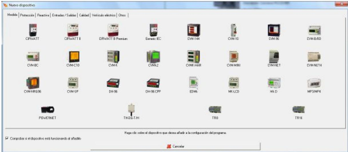
La opción 'Comprobar si el dispositivo está funcionando al añadirlo' indicará al software si una vez añadido debe verificar la conexión y dar el mensaje de error si el dispositivo no está o funciona incorrectamente. En el caso que al añadirlo no se quiera realizar esa comprobación, bien porque no este aún instalado o por cualquier otro motivo, se deberá deseleccionar esta opción.
