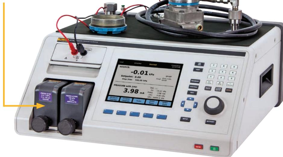
Utilice el modelo 2271A para llevar a cabo una calibración de bucle cerrado totalmente automatizada de dispositivos de 4-20 mA, como este transmisor.
