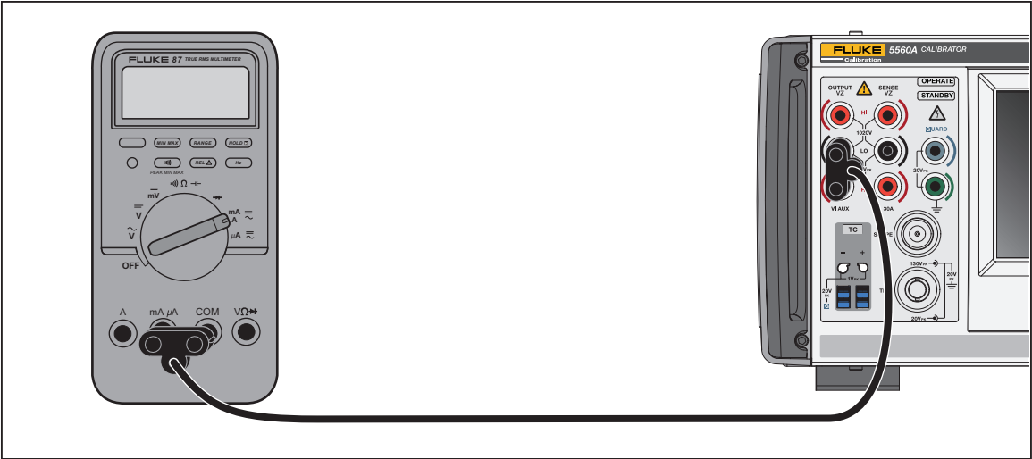
Figura 7. Conexión del DUT: Corriente CC/CA <3,1 A
