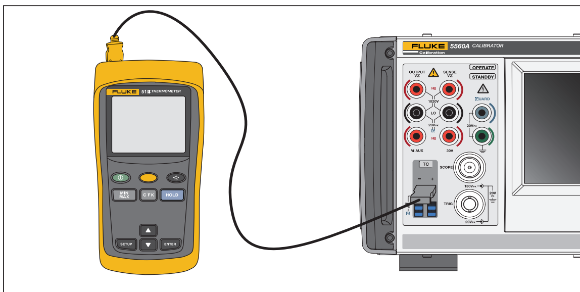
Figura 10. Conexión del DUT: Temperatura (termopar)
