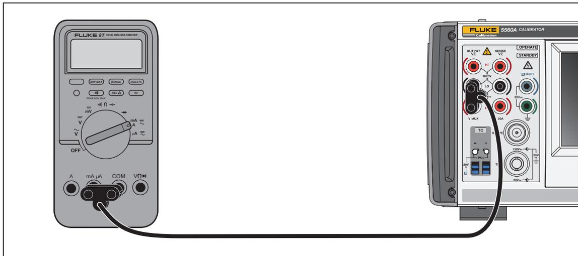
Figura 7. Conexión del DUT: Corriente CC/CA <math>< 3,1 A</math>
