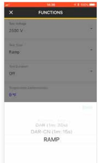
Gracias al funcionamiento remoto del medidor de aislamiento puede utilizar el smartphone para configurar una prueba de rampa que finaliza a 2500 V. Estos parámetros se pueden introducir desde una distancia segura lejos de la unidad que se está comprobando y de cualquier otro equipo potencialmente peligroso.
