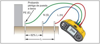
Figura 12. Conexión de prueba de la resistencia de tierra
