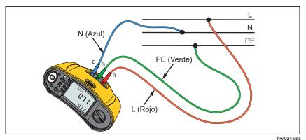
Figura 13. Conexión trifilar para la comprobación de lazo de
