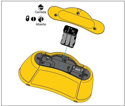
Figura 17. Sustitución de las baterías
