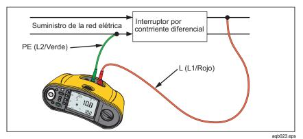
Figura 8. Conexión para prueba de DCR en sistemas eléctricos IT
