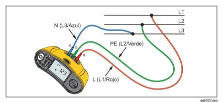
Figura 10. Conexión de comprobación de rotación de fases
