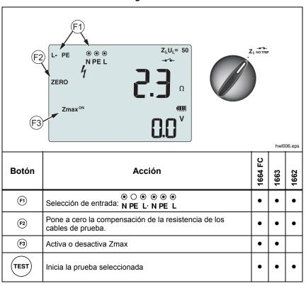
2. Pulse  $\bigcirc$  para seleccionar L-PE. La pantalla muestra los indicadores  $Z_L$  y  $\longrightarrow$  .
