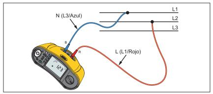
Figura 7. Medición de un sistema trifásico
