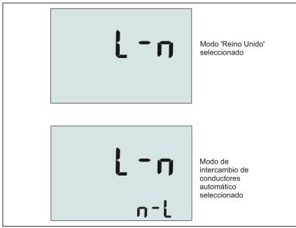
Figura 1. Modos de intercambio de conductores
