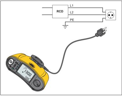
Figura 9. Configuración de cable de prueba individual
