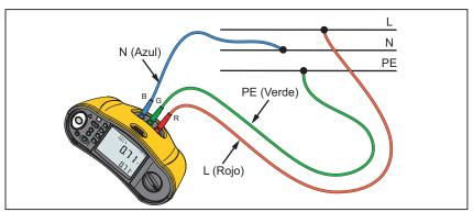
Figura 4. Conexión para prueba previa de seguridad
