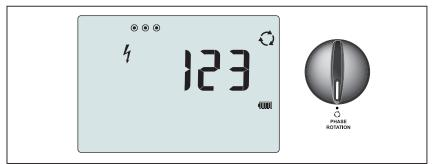
Figura 11. Pantalla de rotación de fases
