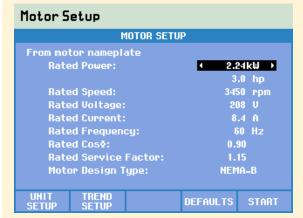
Ingrese los detalles del motor de la placa de especificaciones, incluida la potencia nominal, la velocidad nominal y el tipo de motor, ya sea de clasificación NEMA o IEC.
