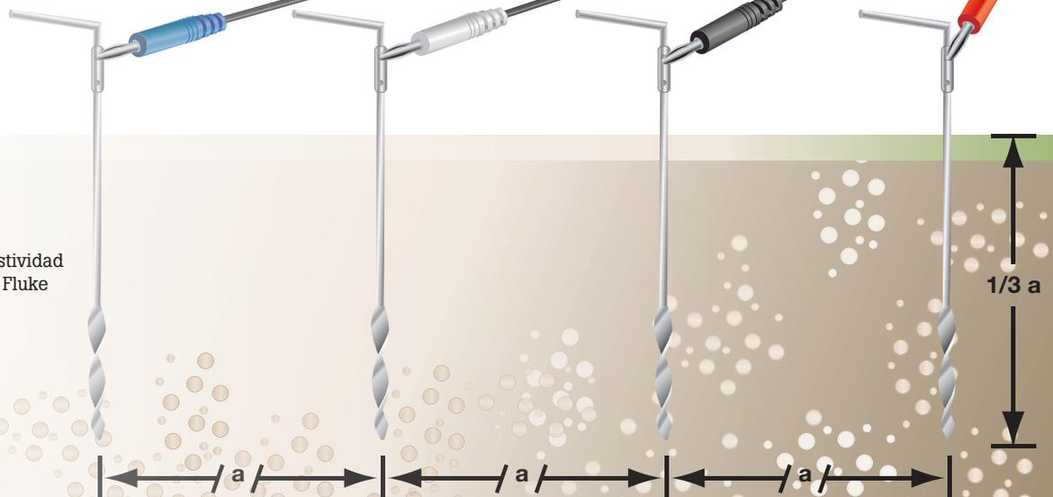
Configuración para la comprobación de la resistividad del terreno utilizando el Fluke 1623-2 o 1625-2.
