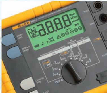
Utilice el Fluke 1625-2 para determinar el estado de sus sistemas de conexión a tierra.
