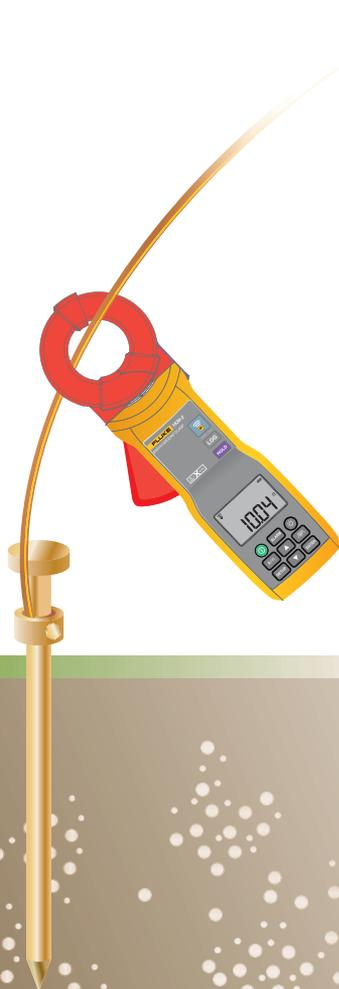
Configuración para el método sin picas utilizando el 1630-2 FC.
