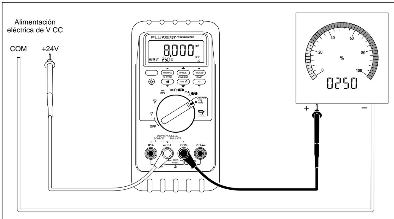
Figura 8. Simulación de un transmisor
