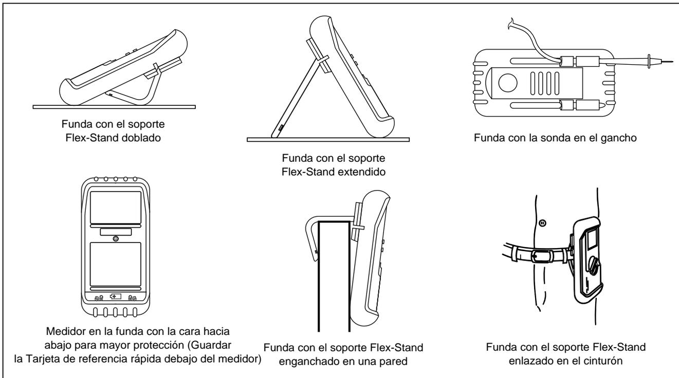
**Figura 9. Uso de la funda y del soporte Flex-Stand**
