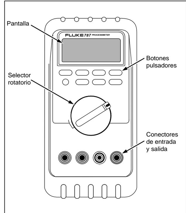
**Figura 1. Fluke 787 ProcessMeter**
