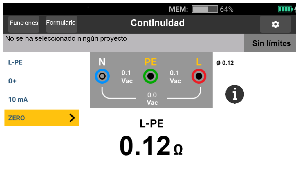
Figura 10. Pantalla de medición de continuidad
