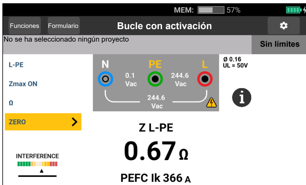
Figura 12. Pantalla de medición de impedancia de bucle con activación
