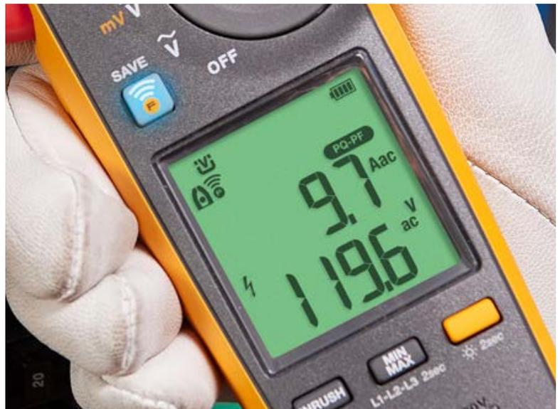
La 378 FC incluye una prueba de calidad eléctrica que indica rápidamente si existe un problema en la acometida o en el equipo.
