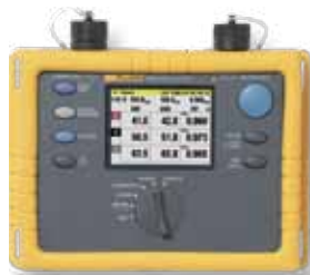
Registrador trifásico Fluke 1735
