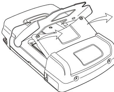
Figura 4-4. Retirada de la tapa de la batería
