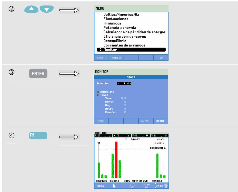
A la función de supervisión de la calidad de la energía eléctrica se accede mediante la selección de MONITOR con la tecla MENU. Un menú de inicio permite seleccionar el inicio inmediato (Immediate) o el temporizado (Timed). Las teclas de flecha izquierda/derecha permiten situar el cursor en un determinado gráfico de barras. Los datos de medida pertenecientes a la barra se muestran en el encabezado de la pantalla.
