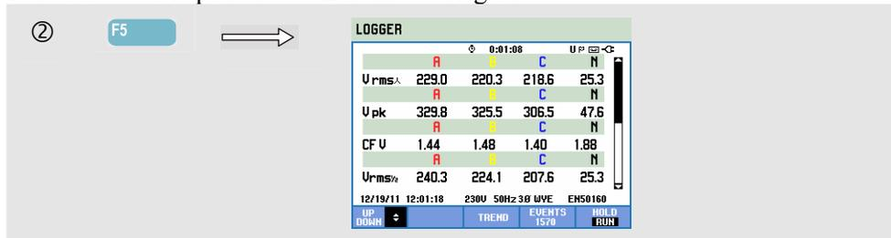
Esta pantalla muestra todas las lecturas actuales de la función del registrador. Utilice las teclas de flecha hacia arriba/hacia abajo para desplazarse por la pantalla de multímetro.
