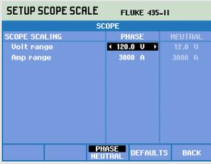
Pulse la tecla de función F2 para acceder a la escala de la pantalla de osciloscopio.
