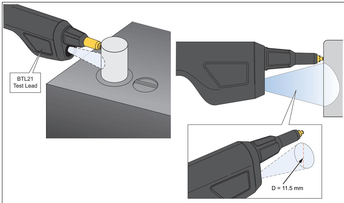
Figura 4-5. Medición de la temperatura de un polo de la batería
