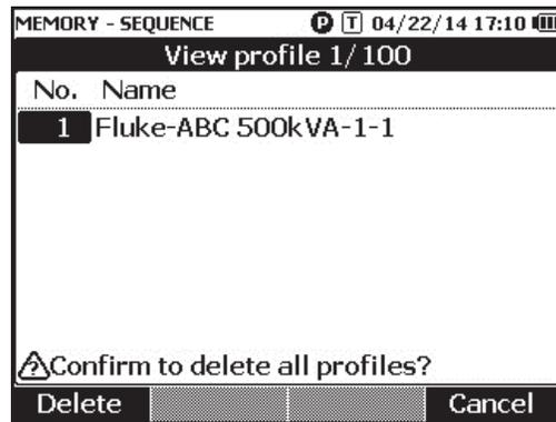
4. Cuando aparezca en la pantalla **Confirm to delete all profiles?** (Confirmar y eliminar todos los perfiles), pulse la tecla **Delete** (Borrar).
