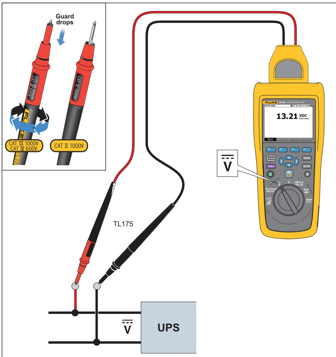
Figura 3-6. Medición de tensión CC con TL175
