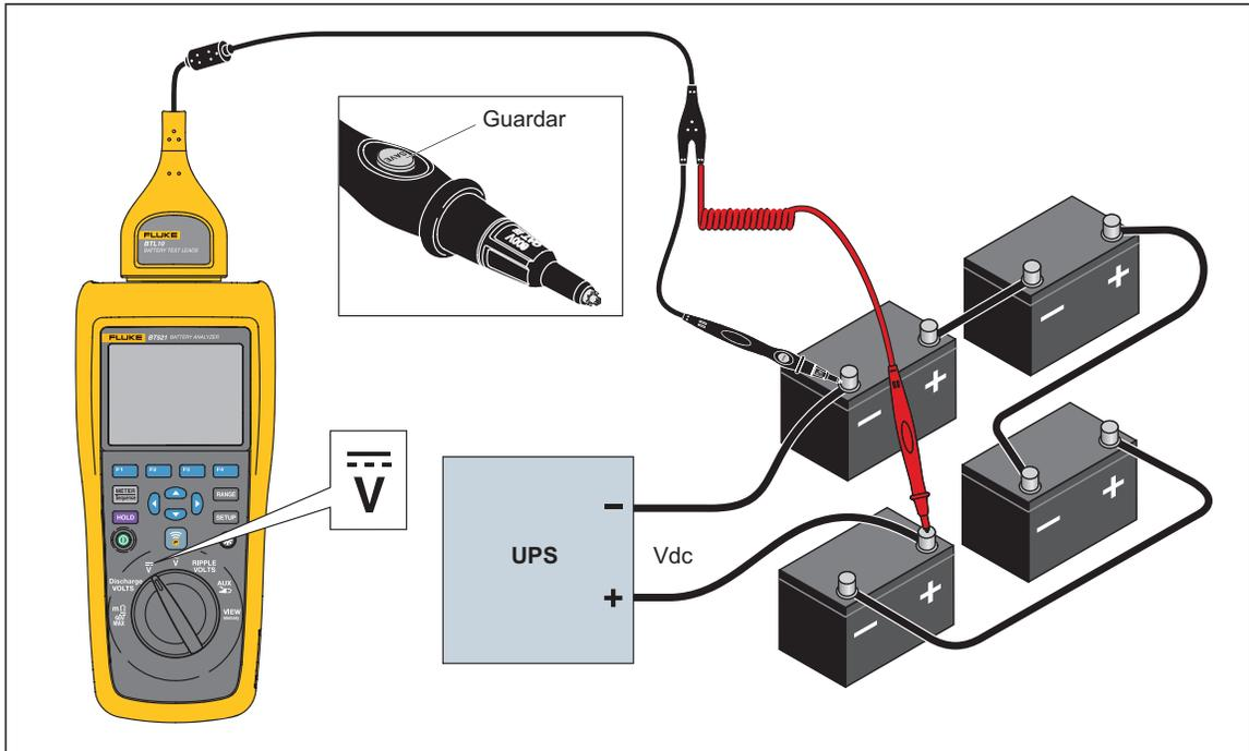
Figura 3-3. Medición de la tensión de CC
