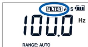
Cada vez que se oprima
