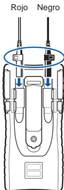
Al conectar las puntas de medición al instrumento, empújelas tanto como sea posible dentro de las terminales de medición mientras sostiene el extremo de los conectores.
