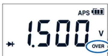
El voltaje de circuito abierto es, aproximadamente, 2,5 V o menos. Para no dañar el objeto de medición, verifique sus especificaciones antes de usarlo.
