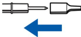
Introduzca las puntas de metal de las puntas de medición en los orificios de las fundas y empújelas con firmeza hacia adentro.
