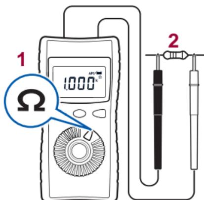
El voltaje de circuito abierto es, aproximadamente, 2,0 V o menos. La corriente de medición (CC) varía dependiendo del rango.
