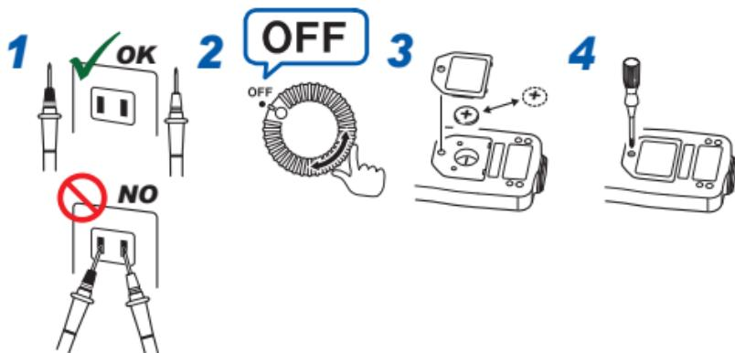
No inserte el tornillo de ajuste en la cubierta de la pila. Esto puede hacer que el instrumento ofrezca unos valores medidos anormales.
