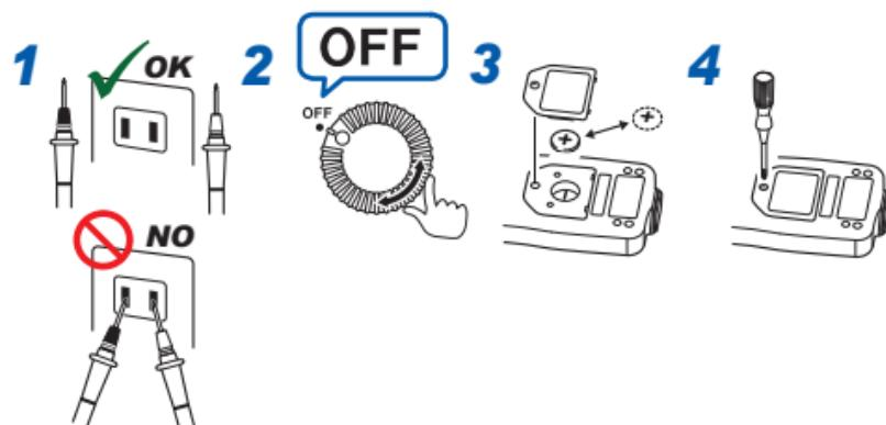
Non girare la vite di regolazione all'interno del vano batterie. Ciò potrebbe causare la misurazione di valori anomali da parte dello strumento.
