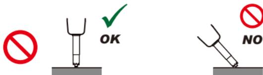
Evite exponer la punta de la sonda de temperatura a golpes y evite doblar en exceso la punta. De hacerlo podría dañar la sonda o romper un cable.
