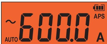
La retroiluminación de advertencia funciona solo para el valor medido presente. La retroiluminación de advertencia no funciona para el valor congelado ni para los valores registrados de las funciones de visualización MAX, MIN, AVG, PEAK MAX y PEAK MIN.
