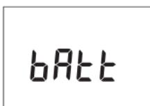
Cuando la carga de pila sea de 0% (menos que 3,0 V ±0,1 V), [bAtt] en la pantalla parpadea durante 3 segundos y la alimentación se apaga.
