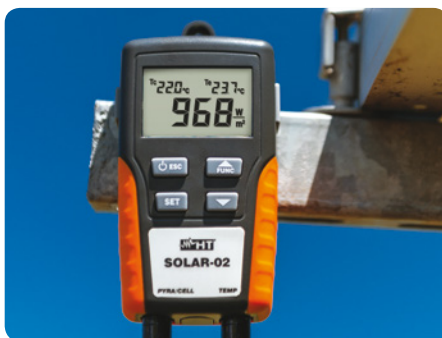
Unidad remota Solar02.
