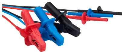
**Clasificación del aislamiento de los cables:** 12 kV CC (marcado en el cable)
