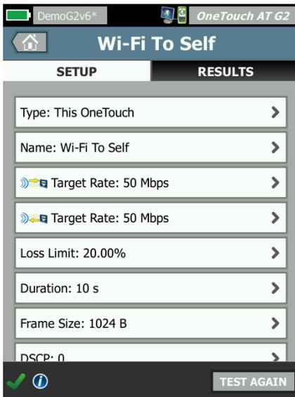
Figura 11: Configuración sencilla para verificar Wi-Fi o throughput de Ethernet con cables contra un punto final en la red con cables.
