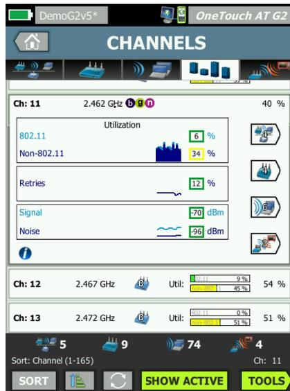
Figura 24: Visibilidad hacia cada canal Wi-Fi, mostrando ancho de banda ocupado por 802.11 y tráfico que no es non-802.11.
