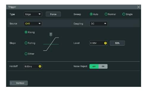
Figure 8.3 Edge Trigger Setting Menu
