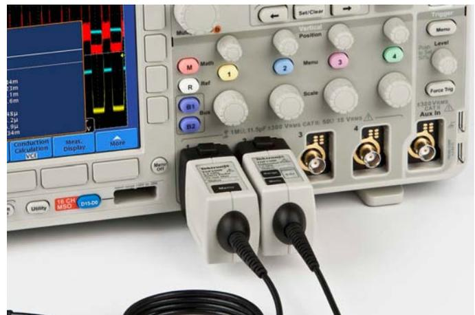
La interfaz de la punta de prueba TekVPI simplifica la conexión de las puntas al osciloscopio.
