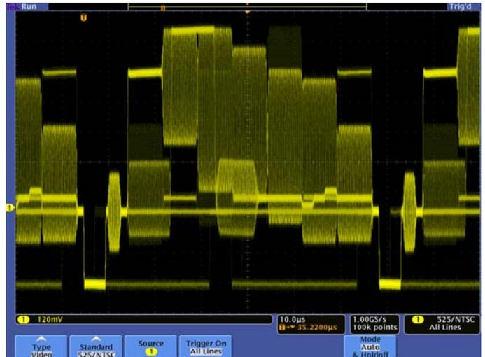
Visualización de una señal de video NTSC. Observe la vista de gradación por intensidad que ofrece la capacidad del DPO para representar el tiempo, la amplitud y la distribución de la amplitud en el tiempo.
