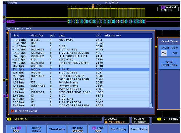
La tabla de eventos muestra el identificador de decodificación, DLC, Datos y CRC de cada paquete CAN en una adquisición larga.
