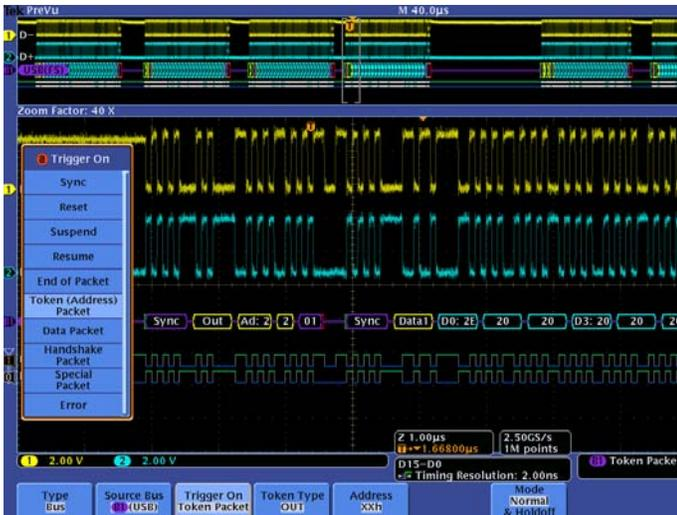
Disparo en un paquete específico de testigos OUT en un bus serial USB de alta velocidad. La forma de onda amarilla es la D+ y la forma de onda azul es la D-. Una forma de onda del bus proporciona el contenido del paquete decodificado, que incluye Inicio, Sincronización, PID, Dirección, Punto final, CRC, Valores de datos y Detención.
