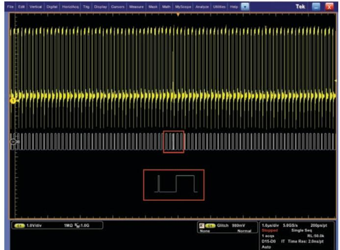
La grabación MagniVu™ de alta resolución ofrece una resolución de sincronización de 60,6 ps, que le permite realizar mediciones de sincronización importantes en sus formas de onda digitales.
