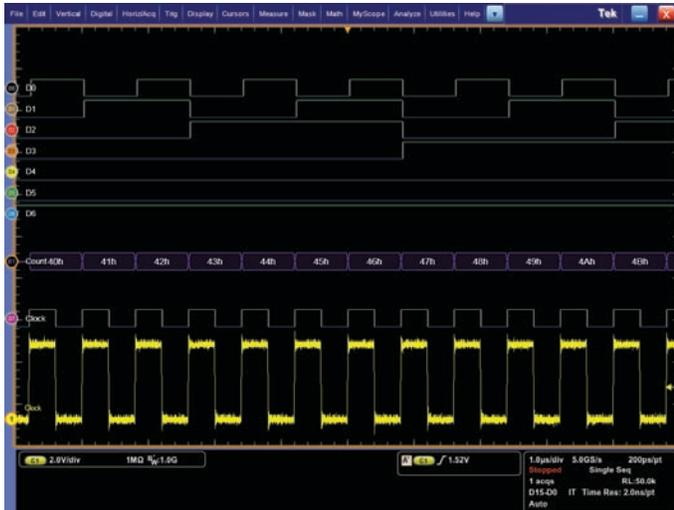
Mediante la presentación de formas de onda digital con codificación de colores, los valores bajos se muestran en azul y los valores altos se muestran en verde, lo que permite un entendimiento instantáneo del valor del bus, ya sea que las transiciones estén visibles o no. Puede establecer los valores de umbral para cada canal y posibilitar la compatibilidad hasta para 16 familias lógicas diferentes.
