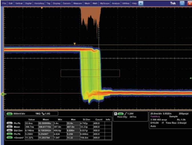
Análisis: el histograma de forma de onda de flanco descendente demuestra la distribución de la posición del flanco (inestabilidad) durante el transcurso del tiempo. Se incluyen las mediciones numéricas realizadas en los datos del histograma de forma de onda. Un conjunto completo de herramientas de análisis integradas aceleran la verificación del rendimiento de su diseño.
