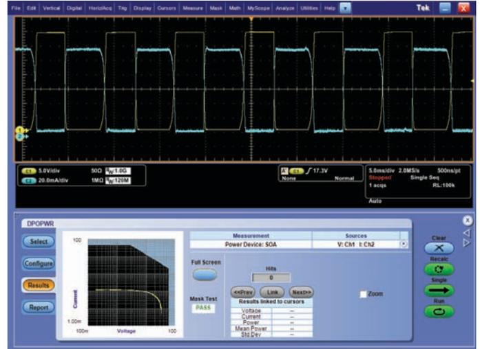
Medición del área de operación segura. Las mediciones de alimentación automáticas posibilitan el análisis rápido y preciso de los parámetros de alimentación comunes.
