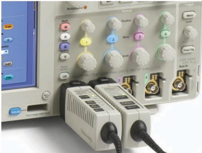
La interfaz de la punta de prueba TekVPI simplifica la conexión de las puntas al osciloscopio.
